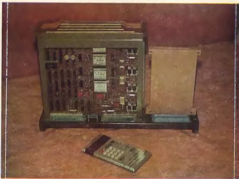
Разработки ЦМД ЗУ Института электронных управляющих машин для СМ ЭВМ с интерфейсами «Общая шина», И-41, МПИ, ИРПС. Модули выполнены в съемном и встроенном вариантах
