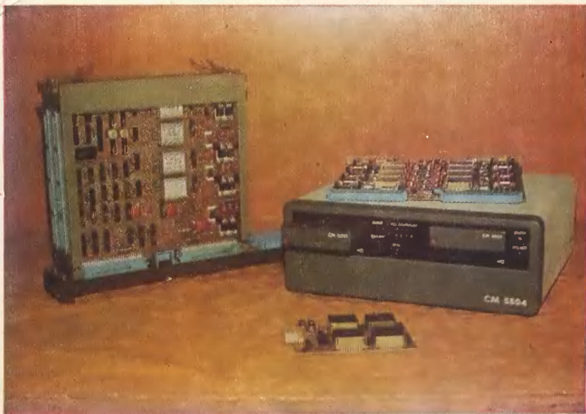
Общий вид доменного запоминающего устройства СМ 5803 емкостью 256К байт ... 1М байт. Модуль накопителя (128К байт) выполнен на печатной плате типа Е-2
